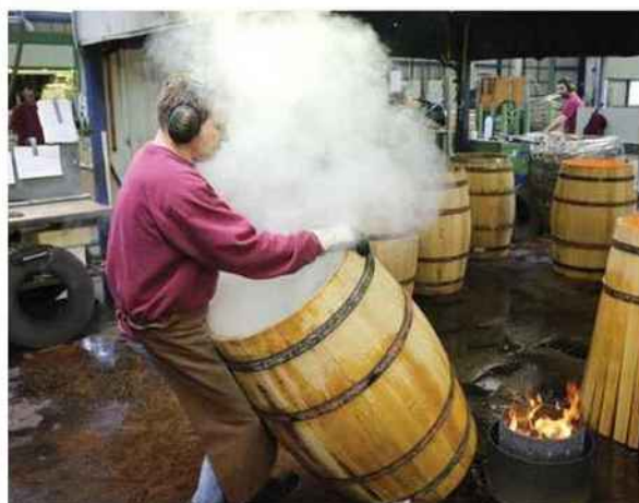
Le bousinage consiste à rendre le bois malléable en le chauffant et en l'humidifiant à la vapeur d'eau.
