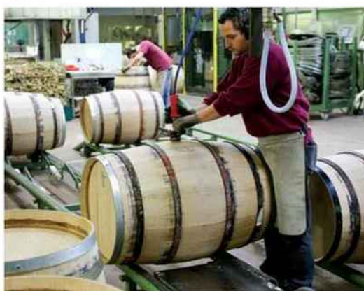
Sept à huit litres d'eau sous pression sont injectés dans le fût afin de s'assurer de son étanchéité.
