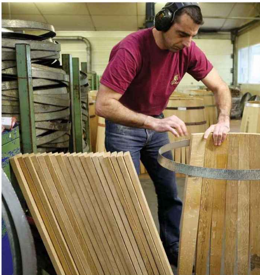
Le tonnelier assemble sa barrique dans un cercle de moule, qui en assure le cintrage.
